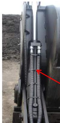
**Flexibles hydrauliques avec spirales métalliques.**
